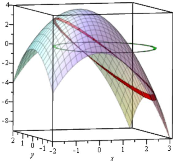
Steigung entlang roter Kurve: Anteil des Gradienten in Tangentenrichtung, also Skalarprodukt
