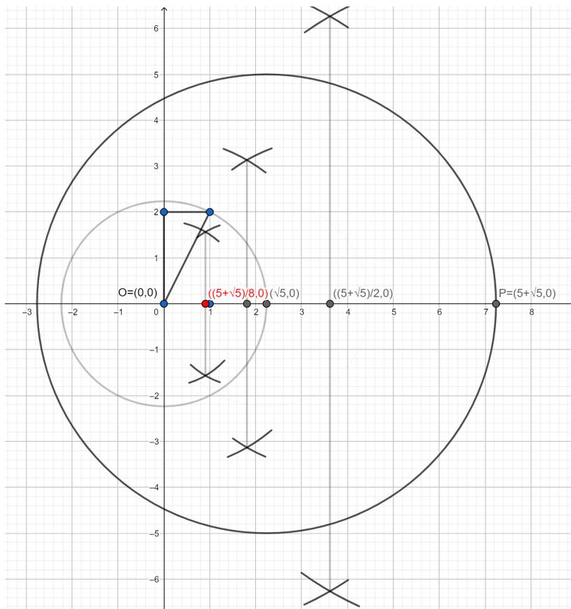
Hierfür konstruieren wir  $\sqrt{5}$  als Hypotenuse eines Dreiecks mit Seitenlängen 1 und 2 und daraus den Punkt  $(\sqrt{5}, 0)$ .
