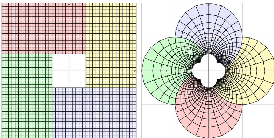
In Polardarstellung gilt  $f(r e^{i\varphi}) = r^{-1} e^{-i\varphi}$ . Geometrisch entspricht diese Abbildung einer Spiegelung am Einheitskreis ( $r \mapsto r^{-1}$ ) sowie einer an der reellen Achse ( $e^{i\varphi} \mapsto e^{-i\varphi}$ ).
