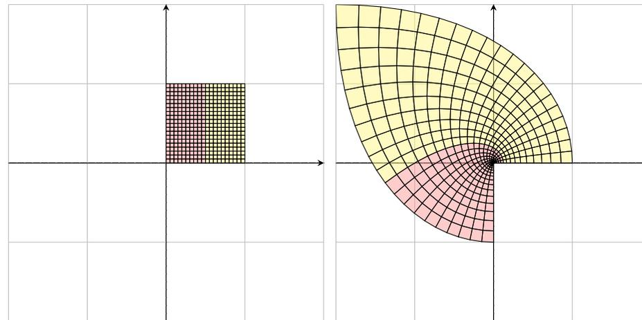
In Polardarstellung gilt  $f(r e^{i\varphi}) = r^3 e^{3i\varphi}$ . Im Ursprung sieht man die Winkelverdreifung. Außerhalb bleiben Winkel erhalten, und kleine Quadrate werden in kleine Quadrate überführt.
