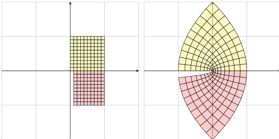
In Polardarstellung gilt  $f(r e^{i\varphi}) = r^2 e^{2i\varphi}$ . Im Ursprung sieht man die Winkelverdopplung. Außerhalb bleiben Winkel erhalten, und kleine Quadrate werden in kleine Quadrate überführt.
