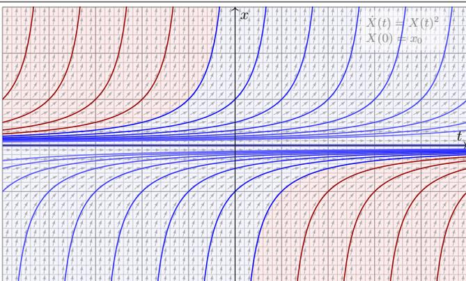
Die Charakteristiken (blau) decken nur einen Teil aller Punkte  $(t, x) \in \mathbb{R}^2$  ab; hier wird der Funktionswert  $u(t, x)$  durch die Anfangswerte bestimmt. Im rot gefärbten Bereich hingegen ist der Wert  $u(t, x)$  unbestimmt.
