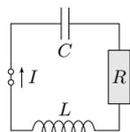
Elektrischer Schwingkreis (RLC), Radioempfänger: Beziehungen zwischen Strom  $I$  und Spannung  $U$ :
