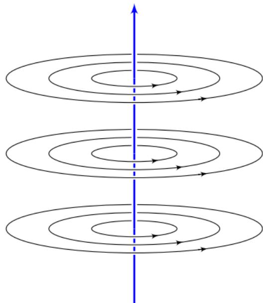
Ein elektrischer Strom längs der  $z$ -Achse erzeugt das Magnetfeld
