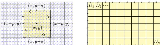
**Aufgabe:** (1) Berechnen Sie (in erster Näherung) das **Arbeitsintegral**  $I_D = \int_{\partial D} f(s) \cdot ds$  von  $f$  längs des Randes  $\partial D$ , als Summe der Kanten. (2) Erklären Sie für  $(\rho, \sigma) \rightarrow 0$  den Grenzwert  $I_D / \text{vol}_2(D) \rightarrow \text{rot } f(x, y)$ . Die Rotation  $\text{rot}(f)$  misst also die **lokale Wirbelldichte** des Feldes  $f$ .
