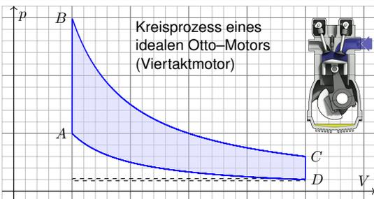
Bei einer Volumenänderung  $dV$  wird die Arbeit  $dW = p \, dV$  verrichtet. Beim Prozess  $\gamma: [t_0, t_1] \rightarrow \mathbb{R}^n: t \mapsto (p(t), V(t), \dots)$  also insgesamt
