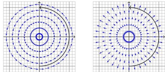
Das Vektorfeld  $f$  können wir uns auch als Strömungsgeschwindigkeit einer Flüssigkeit vorstellen. In der Ebene ergibt das Flussintegral die über  $\gamma$  (von links nach rechts) fließende Flüssigkeitsmenge. Das Kreuzprodukt zählt den normalen Anteil senkrecht zur Wegrichtung.
