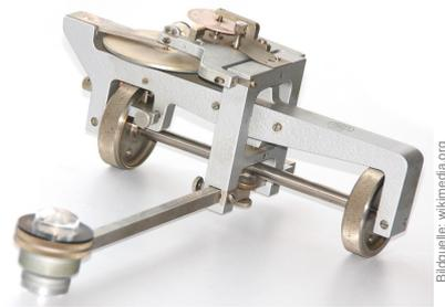
Ein **Planimeter** ermittelt Flächeninhalte, z.B. auf einer Landkarte, indem man den Rand der zu messenden Fläche mit einem Fahrstift abfährt. Dabei integriert eine geeignete Mechanik präzise den Flächeninhalt! Sie können es sogar selbst bauen, siehe YouTube > lego planimeter
