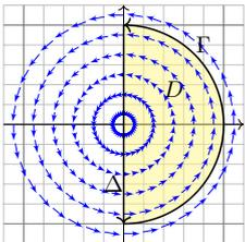
**Aufgabe:** Berechnen Sie das Arbeitsintegral  $\int_{\Gamma} f \cdot d\Gamma$  des Vektorfeldes  $f(x, y) = (-y, x)$  längs des positiv orientierten Halbkreises  $\Gamma$ , des Durchmessers  $\Delta$ , sowie  $\int_D \text{rot}(f) d(x, y)$ .
