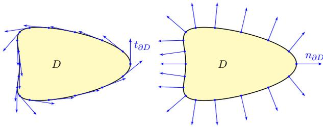
Sei  $\gamma : [a, b] \rightarrow \partial D$  reguläre Parametrisierung eines Randstücks. Ihre Orientierung sei so gewählt, dass  $D$  links von  $\gamma$  liegt. Im Punkt  $s = \gamma(t)$  mit  $a < t < b$  definieren wir den
