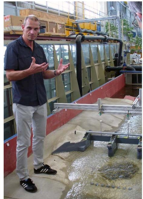
Dr.-Ing. Markus Noack an einem wasserbaulichen Modellversuch eines Hochwasserrückhaltebeckens
