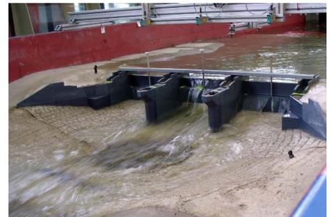
Hydraulische Extremsituation für ein Durchlassbauwerk eines Hochwasserrückhaltebeckens im Modellversuch.
