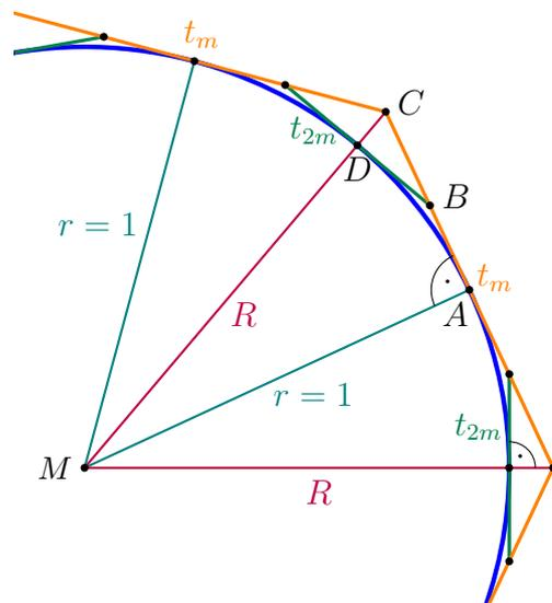
**Lösung:**  $R^2 = 1^2 + \left(\frac{t_m}{2}\right)^2 \stackrel{R \geq 0}{\Rightarrow} R = \sqrt{1 + \left(\frac{t_m}{2}\right)^2} \quad (1)$
