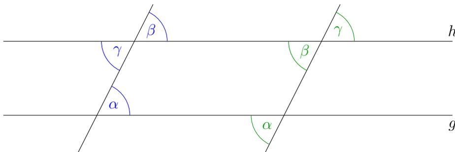
a) Dann sind die **Stufenwinkel**  $\alpha, \beta$  gleich groß. Und umgekehrt:  $\alpha = \beta \Rightarrow g \parallel h$ .
